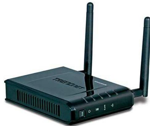
กล่องอุปกรณ์รับส่งสัญญาณไร้สาย ชนิด router เป็นอุปกรณ์ที่ใช้เชื่อมต่อเครือข่ายอินเทอร์เน็ตความเร็วสูงระดับ ADSL ซึ่งออกแบบมา สำหรับจุดประสงค์การใช้งานอย่างหลากหลาย มีคุณสมบัติทำหน้าที่ เป็นทั้ง router, switch และ access point อุปกรณ์ชนิดนี้ ออกแบบมา ให้มีพอร์ตเชื่อมต่อกับคอมพิวเตอร์ แบบใช้สาย จำนวน 4 พอร์ต ผู้ผลิตหลายราย ก็ออกแบบให้มีขนาดเล็ก มีปุ่มสลับโหมดการทำงาน เพื่อให้เหมาะสำหรับการเคลื่อนย้าย
