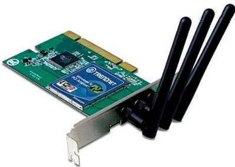
(ภาพที่ 5.7-1) แผงวงจรเครือข่ายไร้สาย ชนิด PCI card
